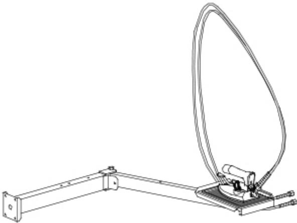
Braccio poggiaferro orientabile. Ferro tutto vapore F318 con tubi, scaricatore e valvola di ritegno. Con dispositivo di sicurezza.
