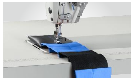
免调试缝制一次性缝制厚料到薄料、网眼网纱
